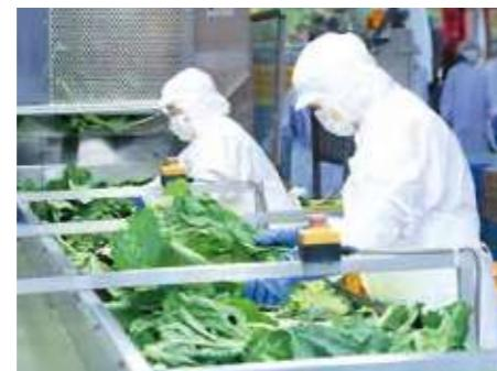
収穫されたケールは工場で商品に加工されます。工場での受け入れ時に、収穫されたケールの厳格な品質検査を行い、安心安全な商品を製造しています。
