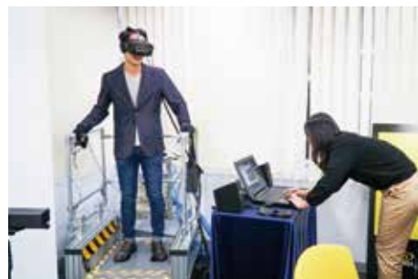
5感再現（視覚+聴覚+触覚+臭覚）する装置。ゴーグルの視界だけでなく、足場が揺れたり、手袋から電流が流れることで、リアルで効果的な体感・訓練ができます。
