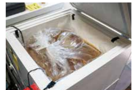
「石見式」と呼ばれる独自の醸造法。9坪の小さいスペースに石見式の発酵タンクが並び、ビニール袋の中で発酵させます。
